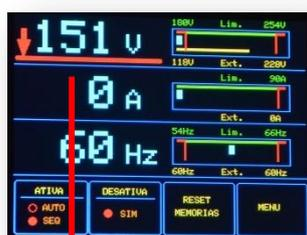
Quando algum parâmetro da rede elétrica ultrapassar os limites programados no B.L.U.E., e se a função 'DESATIVA' estiver habilitada, todas as saídas serão desativadas, o erro da rede será mostrado no display, destacado em vermelho, e o led azul do painel ficará piscando.
