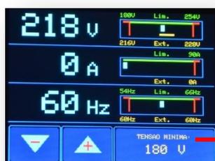
Após tocar em 'MENU', toque para escolher o parâmetro a ser alterado, que são Tensão baixa e alta, Corrente alta, Frequência baixa e alta e Tensão da Rede, e altere o valor do parâmetro tocando nas teclas '-' ou '+'. Toda alteração é sempre gravada na memória do B.L.U.E., e para sair da edição, toque fora do campo de edição, ou após 30 segundos sem tocar no display, ele sairá do modo de edição e entrará no modo de repouso.
